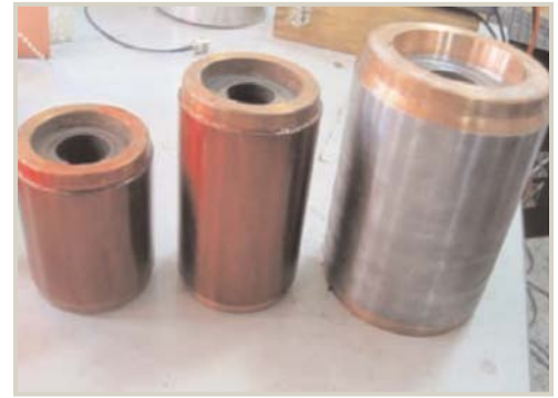
Rotores moldeados a presión con prensa vertical en NFTDC
