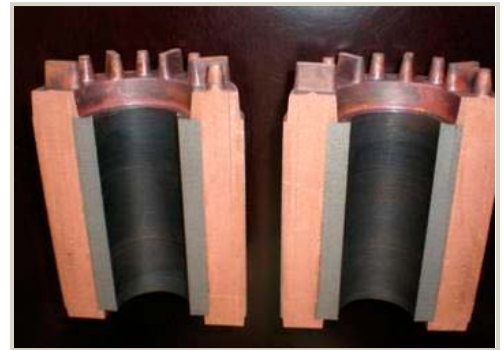
Vista transversal de las barras de rotor y corona de extremo en un rotor de cobre moldeado a presión para motores
